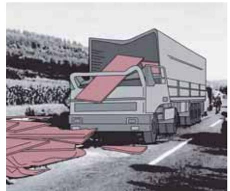
Beim Gütertransport treten durch Beschleunigungs- und Bremsvorgänge, durch seitliche Fliehkraft oder durch Erschütterungen Kräfte auf, die annähernd das Eigengewicht der Ladung erreichen. Dadurch kann die Ladung verrutschen und es kann zu schweren Sachschäden sowie zu Unfällen mit
