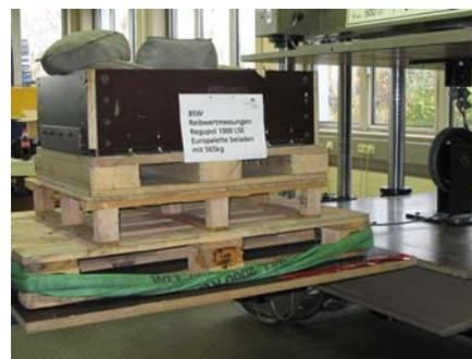
Zugkraftmessung mit Euro-Holz Palette, Kufen parallel zur Zugrichtung
